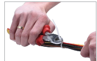
1.4 - Odciąć wystającą część opaski za pomocą szczytpeć, zostawiając kilka mm jako zabezpieczenie
