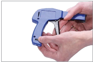
2.1 - Zaciąganie opasek kablowych za pomocą narzędzia - ustawić maksymalną siłę napinania opaski przez narzędzie w zależności od rozmiaru opaski
