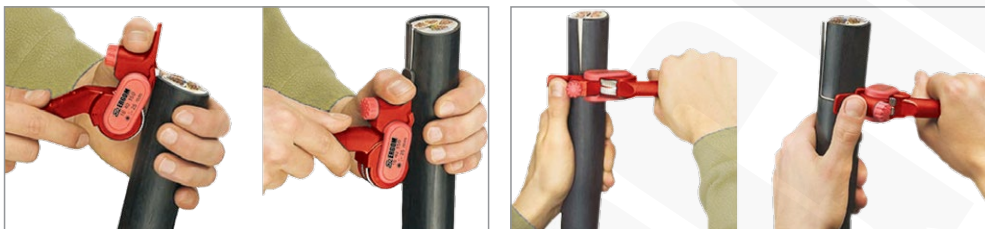
Nacinanie "wzdłużne" izolacji
