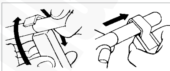
Zdejmowanie izolacji z „końca” kabla
