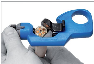
Dobranie głębokości nacinania izolacji
