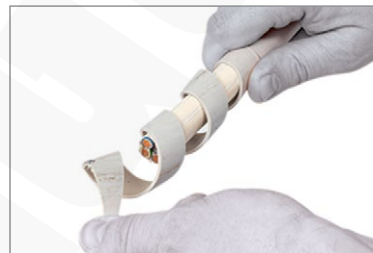
Efekt spiralnego nacinania izolacji
