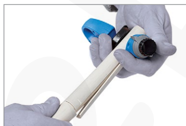
Wzdłużne nacinanie izolacji
