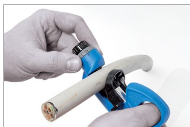
Rozpoczęcie procesu w miejscu od którego ma być ściągana izolacja
