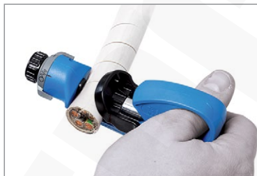
Spiralne nacinanie izolacji
