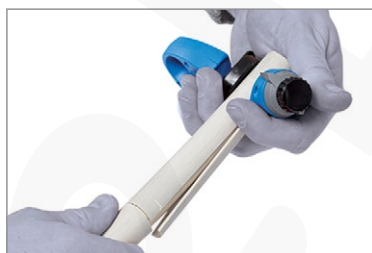
Wzdłużne nacinanie izolacji
