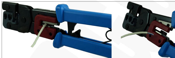
Zdejmowanie izolacji zewnętrznej
