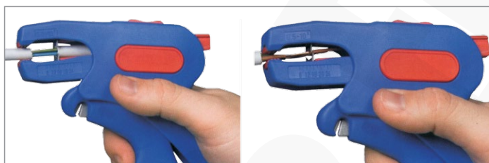
Zdejmowanie izolacji zewnętrznej
