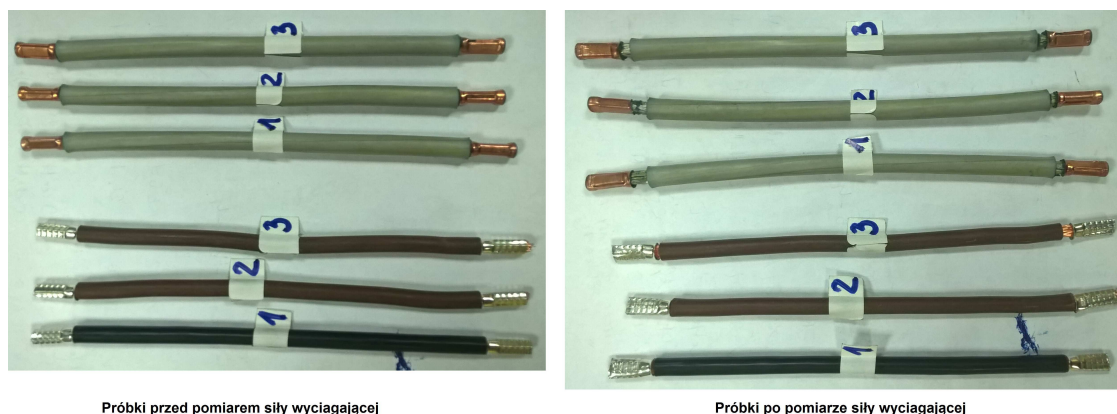
Rys. 6. Próbki z końcówkami przed i po pomiarze siły wyciągającej.
